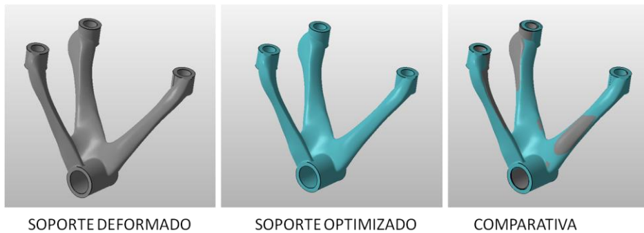
Figura 34. Resultados de la simulación. Cálculo mecánico pieza 2 con tratamiento térmico de AIDIMME
