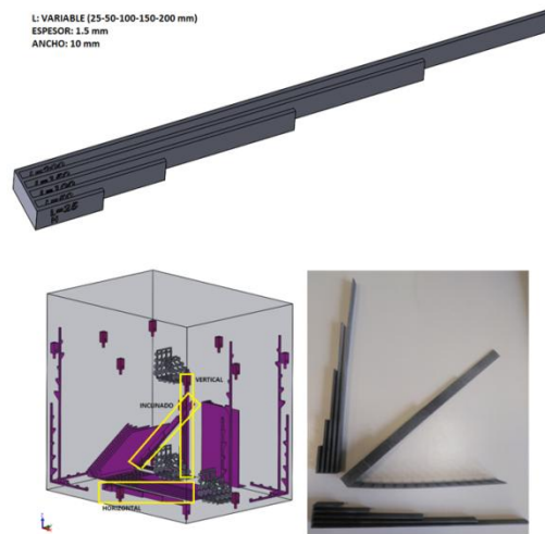
Figura 24. Medidas teóricas y localización de las pletinas en la bandeja de fabricación de MJF
