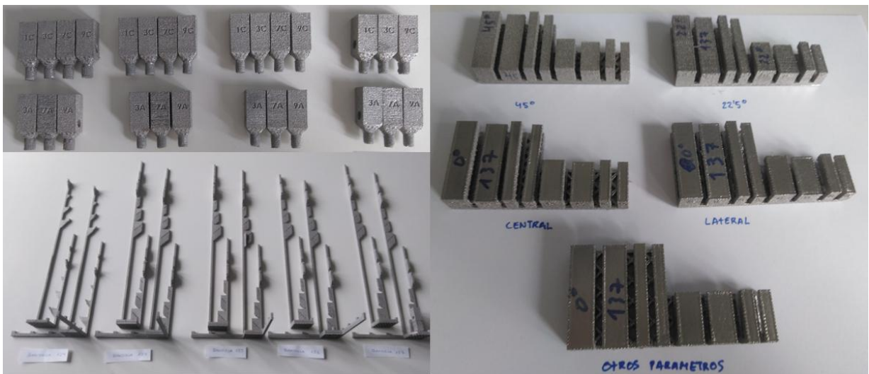
Figura 15. Representación de las piezas fabricadas en Titanio con la tecnología EBM
