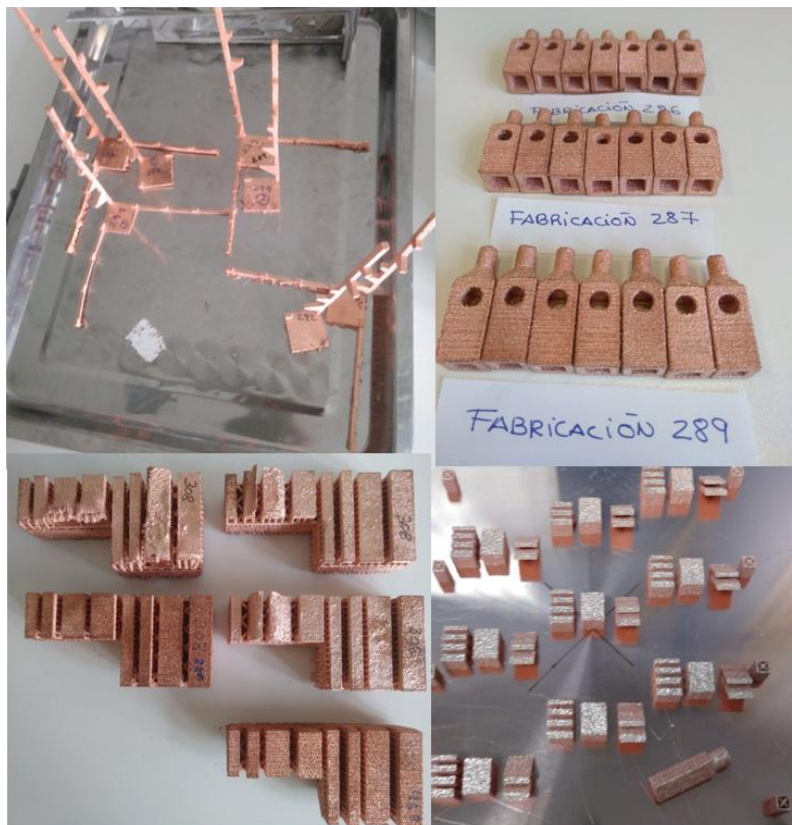
Figura 14. Representación de las piezas fabricadas en cobre con la tecnología EBM
