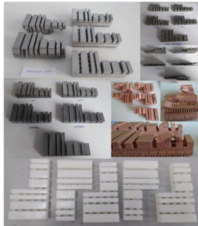
Figura 23. Piezas voladizo fabricadas
