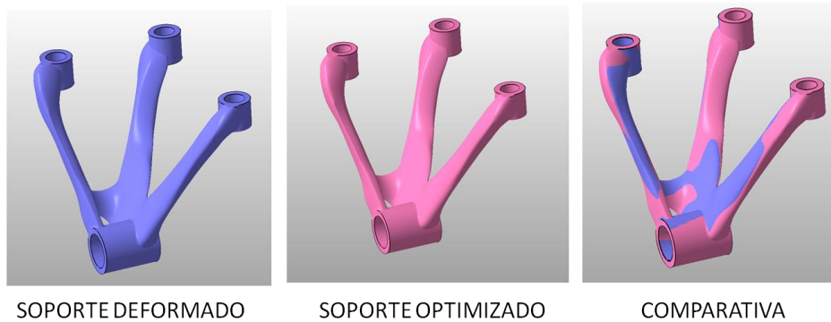
Figura 35. Resultados de simulación. Cálculo termo-mecánico pieza 2 con tratamiento térmico de AIDIMME
