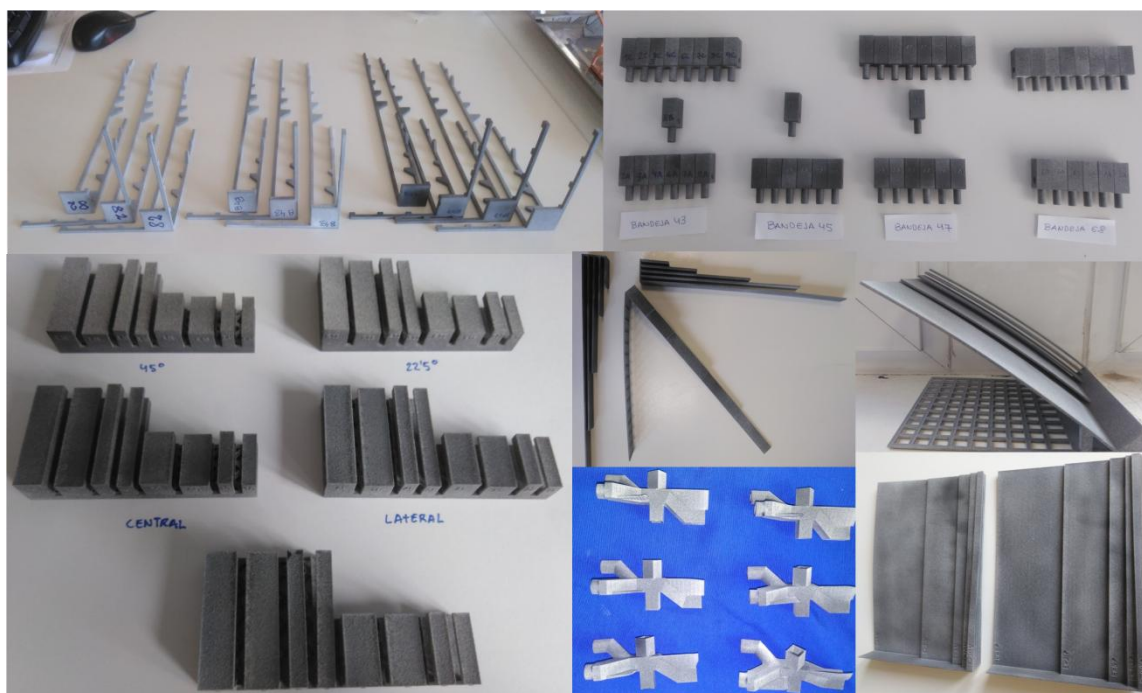
Figura 13. Representación de las piezas fabricadas en poliamida 12 mediante la tecnología MJF
