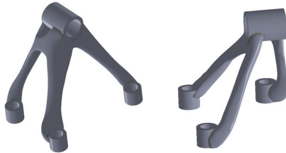
Figura 12. Diseño de soporte para el diseño de la contradeformada
